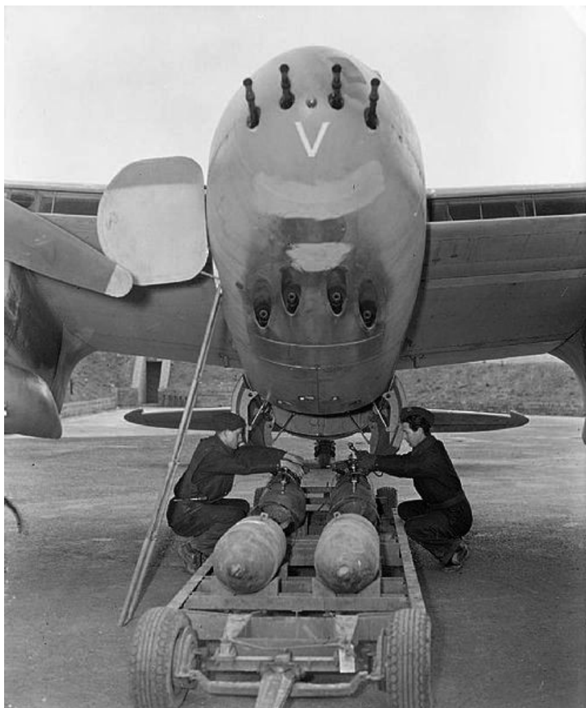
En Royal Air Force de Havilland Mosquito jager fotograferet direkte forfra, hvor man ser flyets 20 fire mm maskinkanoner øverst på flyets næse. Nederst de fire 7 mm maskingeværer.
