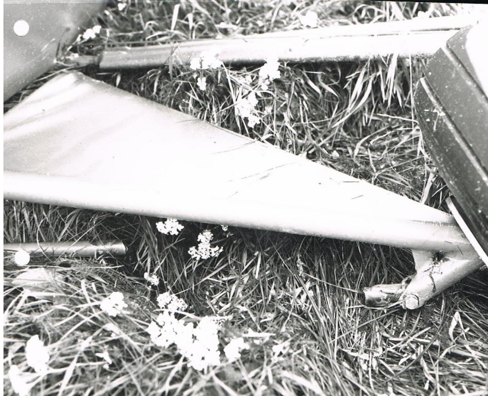
Venstre øverste understelsben brudt sammen.
