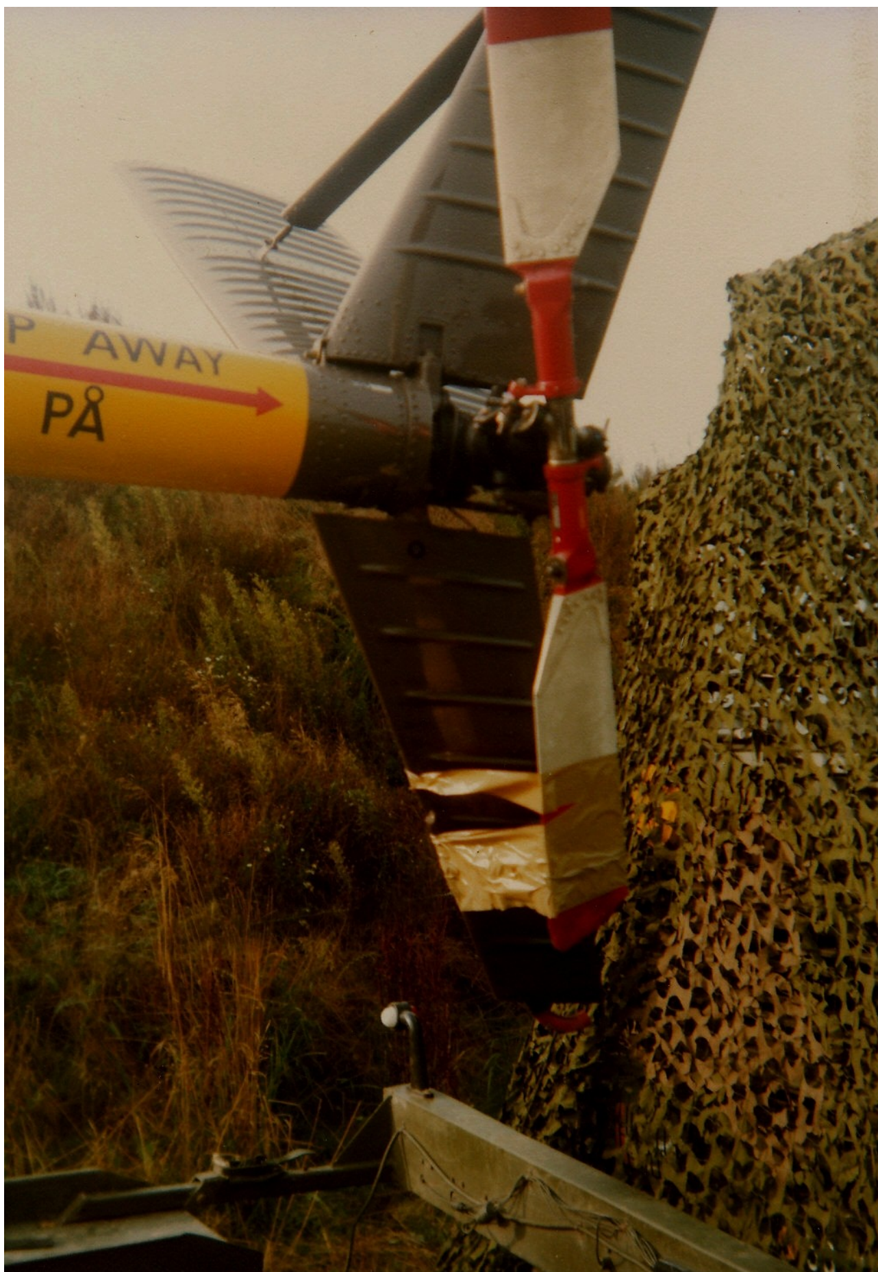
Halerotoren på H-210 efter den havde været ned for at snuse til den tyske muld. Som det ses, havde den ikke godt af det. (Billede fra LAU's Arkiv).
